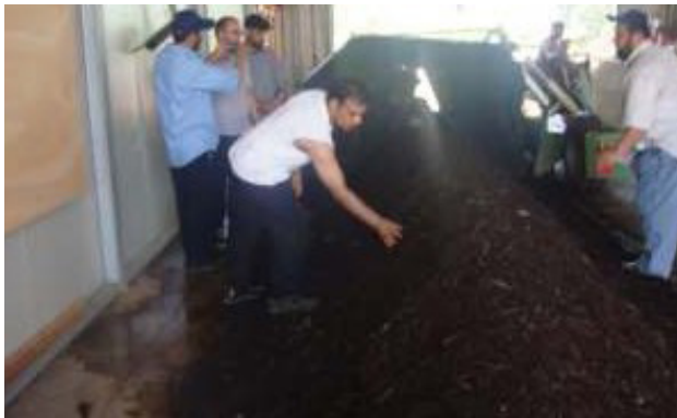
عمليات التقليب الدوري عند وصول الحرارة ٥٠ - ٧٠ م٥
