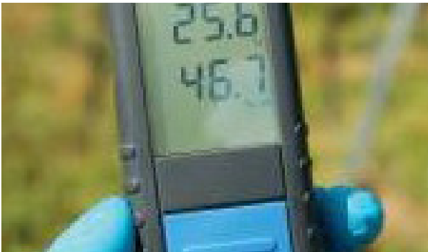
جهاز قارئ لدرجة حرارة ورطوبة الكومبوست
